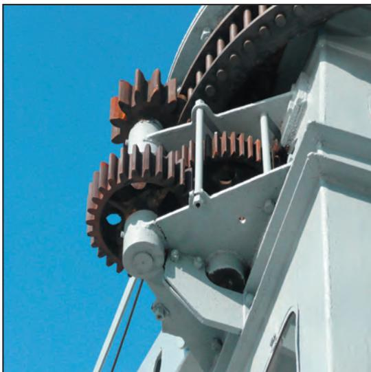
Fig. 23 - Particolari degli ingranaggi di rotazione
