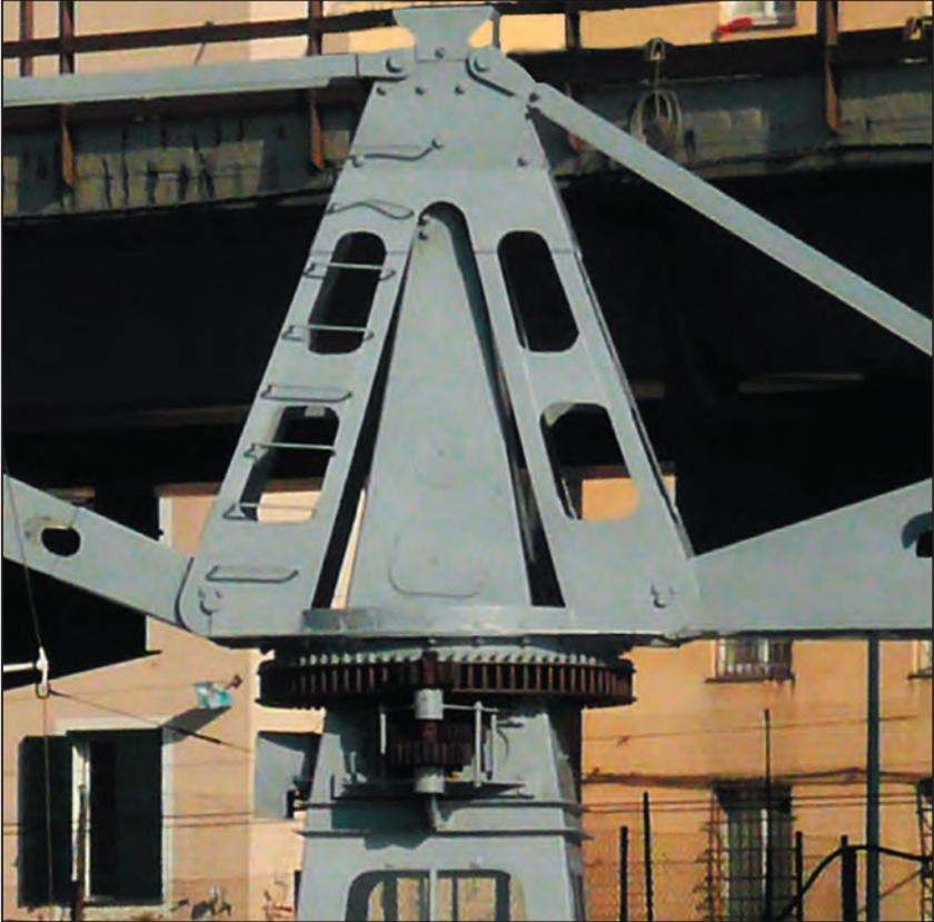
Fig. 24 - Particolari degli ingranaggi di rotazione
